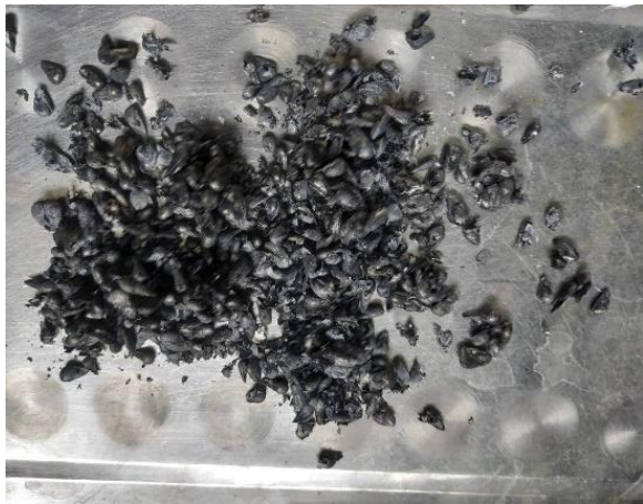
ภาพถ่านชีวภาพจากกากเมล็ดลูกยอ โดยกระบวนการไพโรไลซิส
